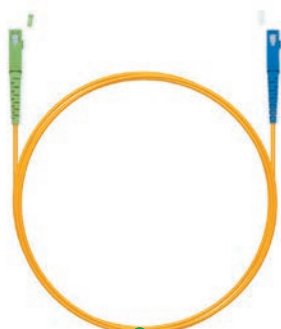
Шнур оптический spc SC/UPC-SC/APC 9/125 3.0мм 5м LSZH (патч-корд)
