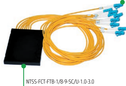
Разветвитель сплавной 1x8 оконцованный SC/UPC 9/125 вывод 1м буфер 3.0мм 1310/1550
