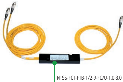
Разветвитель сплавной 1x2 оконцованный FC/UPC 9/125 вывод 1м буфер 3.0мм 1310/1550
